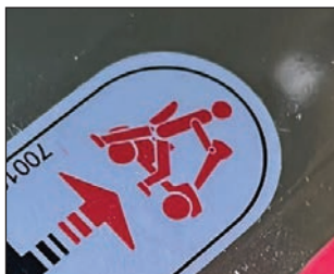
Vrijloophendel omhoog: - met de hand verrijdbaar - rem is NIET ingeschakeld!
