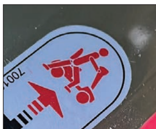
Levier d'embrayage vers le haut : - déplaçable manuellement - le frein n'est pas engagé !
